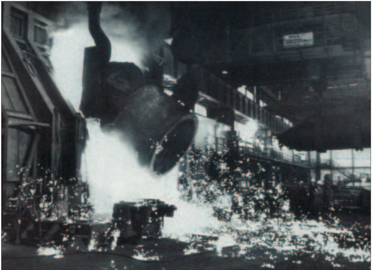
Vertido de arrabio en el crisol.
